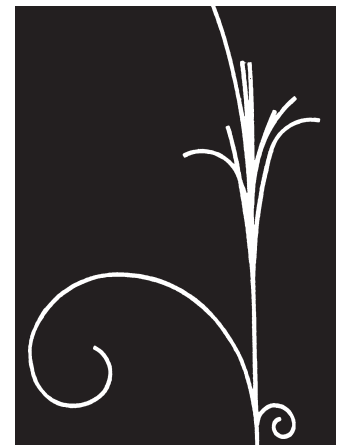
Bild 2.2: Teilchenbahnen im Magnetfeld einer Blasenkammer
