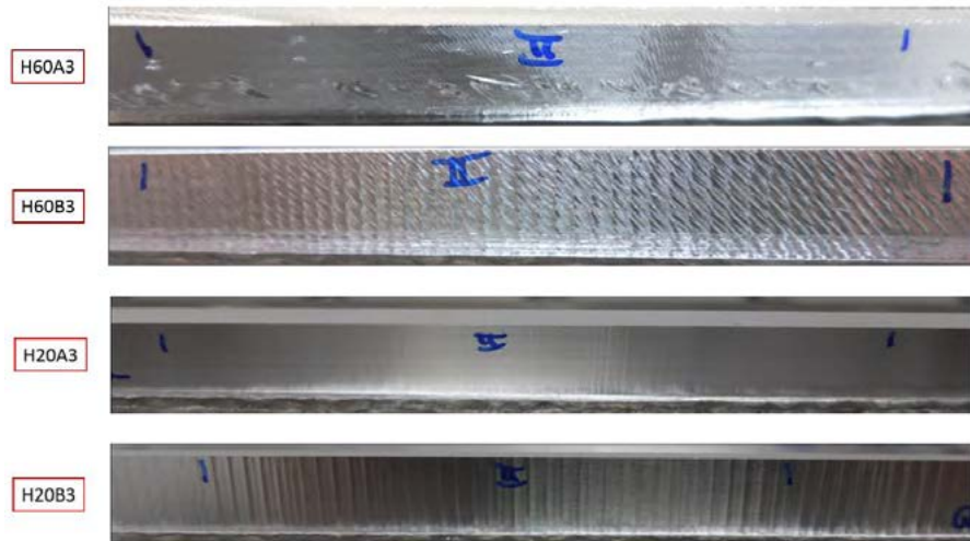
Abbildung 9: Steg mit Gegen- (A) und Gleichlauf fräsen (B) 60 und 20mm Höhe, a_p=10 mm, a_e=0,5 mm,
