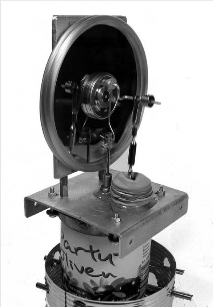
Abb. 4.19 Modell 06 in Betrieb, mit Schwungmasse aus Lautsprecherkabel und Luftballonmembran
