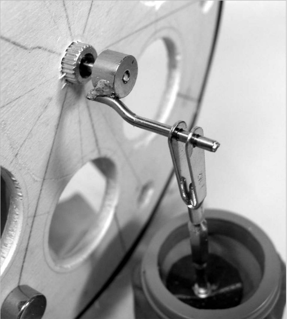
Abb. 4.15 Detail der Kurbel und des Pleuels beim Arbeitszylinder
