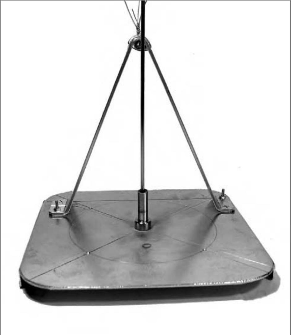
Abb. 4.2 Montage der Durchführung für die Verdrängerstange
