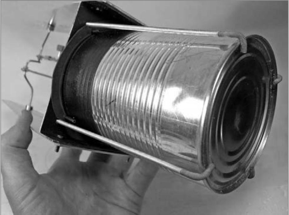
Abb. 4.4 Verschraubung von Dose und Basisplatte mit Gewindestangen
