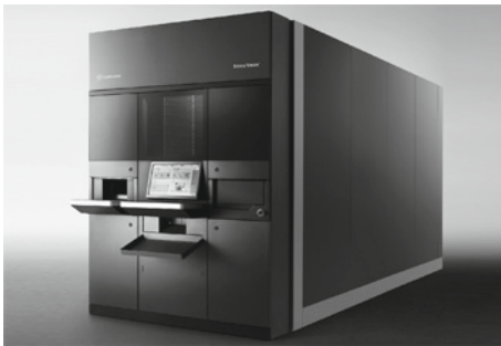
● Abb. 1.4 Statt der Schubladen wird in größeren Betrieben meist ein Kommissionierautomat eingesetzt, der mit oder ohne Rezeptkopplung, die angeforderten Medikamente am Handver-kaufstisch (auch Tresen, HV) direkt ausgibt. Eine Apothekerin wählt im Arznei-mittel aus, ein Klick – und Sekunden später rutscht die Faltschachtel durch den Ausga-be-schacht in den Verkaufsraum der Apotheke. Ein Automat mit Sauggreifer im Hinter-grund macht es möglich. Foto: CAREFUSION Germany 326 GmbH
