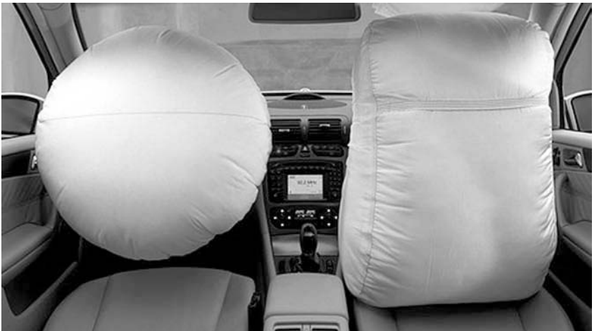
Bild 1.2 Kombination Fahrer- und Beifahrer-Airbag (Quelle: Mercedes-Benz)
