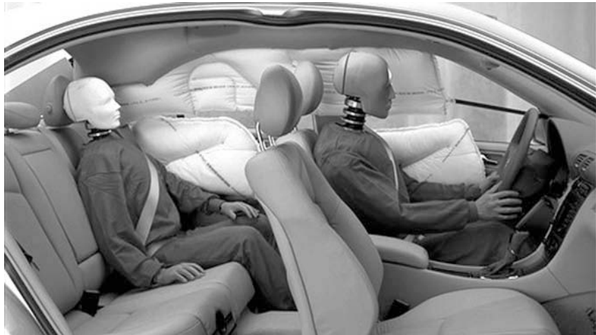
Bild 1.3 Kombiniertes System Windowbag, Seitenairbag vorn und Seitenairbag hinten (Quelle: Mercedes-Benz)
