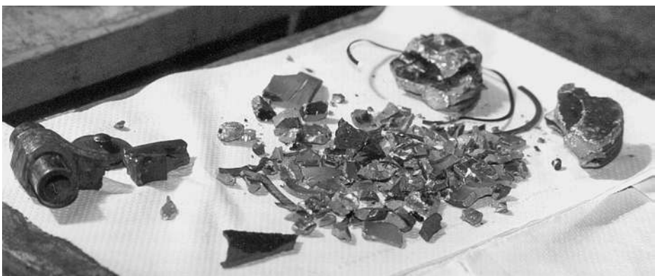
Bild 1.2 Totalschaden eines Motors als Folge eines Kolbenfressers
