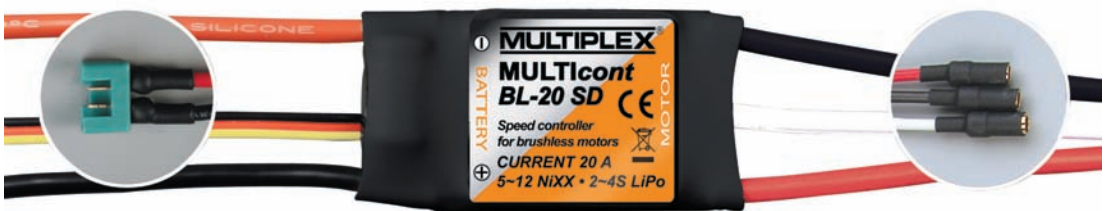
Abb. 2.6 – Der Flugregler MULTiCont BL-20 SD-L ist klein und unscheinbar. Mit den Kabeln an der linken Seite ist die Verbindung zum Flugakku und zum Fernsteuerungsempfänger herzustellen. An die drei Buchsen der rechten Kabel ist der Brushless-Motor anzuschließen. (Quelle: Multiplex)
