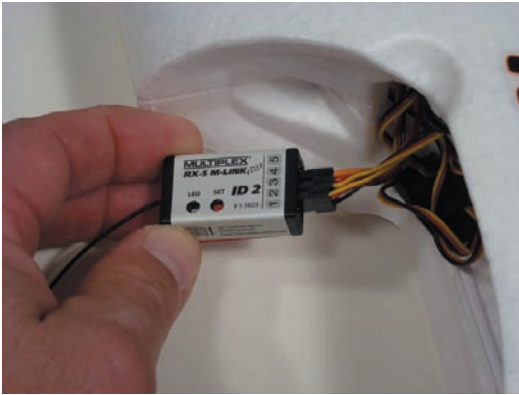
Abb. 2.9 – An dieser Seite sind die zu steuernden Servos und der Flugregler anzustecken.
