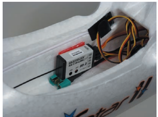
Abb. 2.8 – Der Empfänger ist im Modell eingebaut. Er gibt die vom Sender empfangenen Steuersignale an den Flugregler und die zu steuernden Servos weiter.
