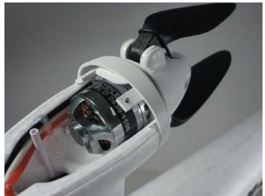
Abb. 2.4 – Im EasyStar II arbeitet ein Brushless-Motor mit einer Dauerleistung von 235 W.
