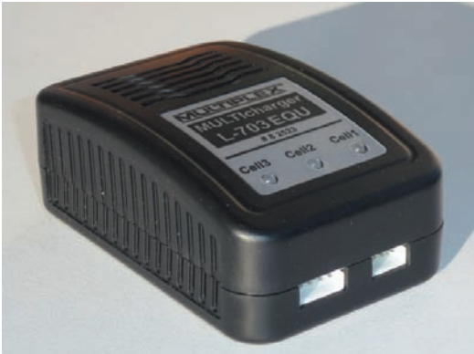
Abb. 2.10 – Im RTF-Set des Multiplex EasyStar II ist ein Ladegerät des Typs Multicharger L-703 EQU enthalten. Mit diesem können 2- und 3-zellige LiPo-Akkus geladen werden.
