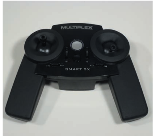
Abb. 2.7 – Der Fernsteuersender ist mit zwei Steuerknüppeln ausgestattet. Über sie werden die Motordrehzahl und die Ruder am Flugmodell gesteuert.
