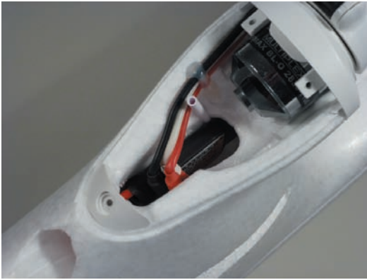
Abb. 2.5 – Der Motor wird über den Flugregler angesteuert. Er ist im EasyStar II kaum sichtbar verbaut.
