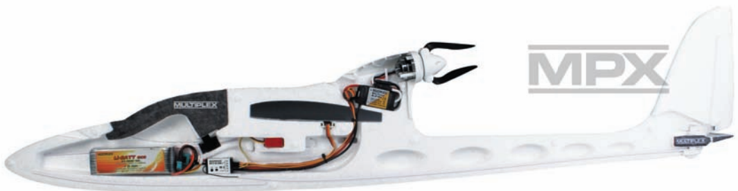
Abb. 3.2 – Der Längsschnitt durch den EasyStar II zeigt von links nach rechts den Akku, den Fernsteuerungsempfänger, den Flugregler und im Pylon den Motor und die Klapppropeller. (Quelle: Multiplex)
