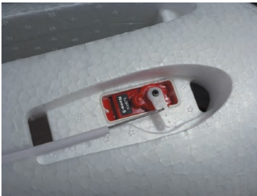
Abb. 2.3 – Servos dienen zum Ansteuern der Ruder. Sie haben einen Drehbereich von \pm 45^\circ und können gradgenau gesteuert werden.
