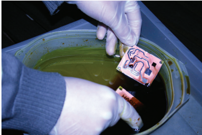
Bild 1.5 Durch Ätzen wird eine zuvor belichtete Leiterstruktur auf das Basismaterial übertragen
